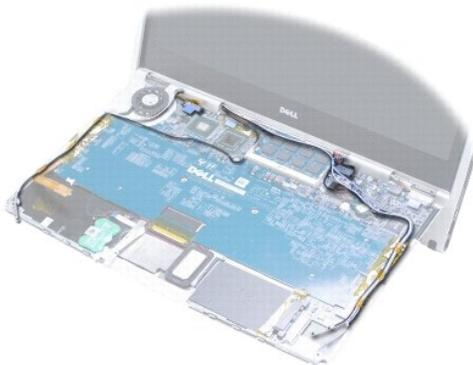
6. Schließen Sie das Kabel der linken Tochterplatine am Anschluss auf der Systemplatine an (siehe [Einsetzen der linken Tochterplatine](#)).
